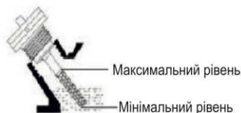
Мал.3. Отвір для заливки масла, щуп і рівень масла
